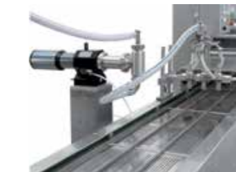
RDK (dosing units)
